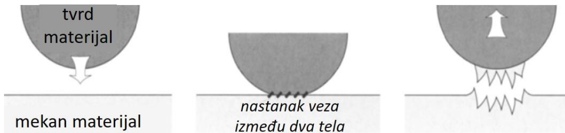
Slika 7.12: Proces transfera materijala usled adhezije
